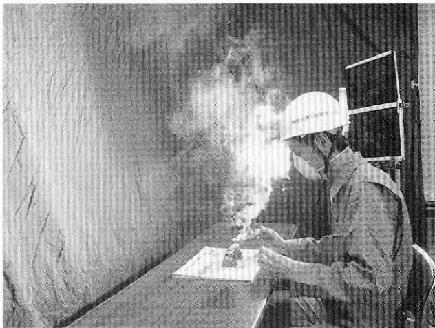
写真 35 ダストランプ使用 ダンパー有 室内照明有 背景暗 角度 45度 作業台暗 露出 f2.8 1/15
