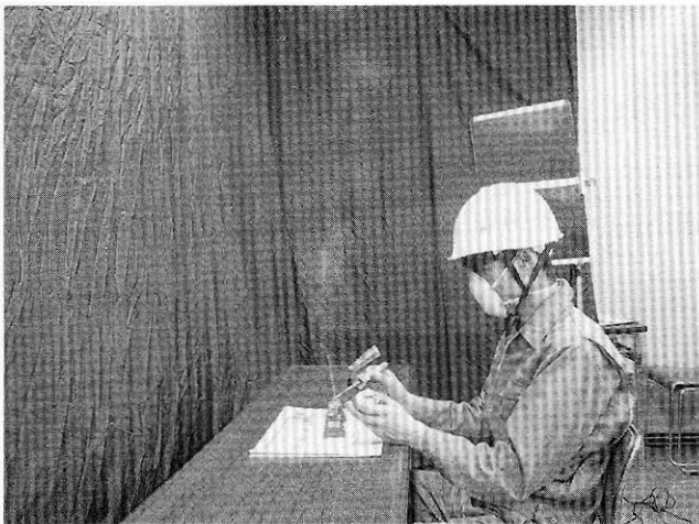
写真 17 ダストランプなし 角度 35度 ダンパー無 作業台暗 室内照明有 背景暗 露出 f2.8 1/8
