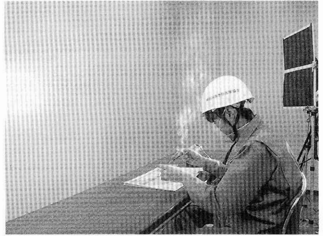
写真 38 ダストランプ使用 角度 55度 ダンパー有 作業台暗 室内照明有 背景明 露出 f2.8 1/15
